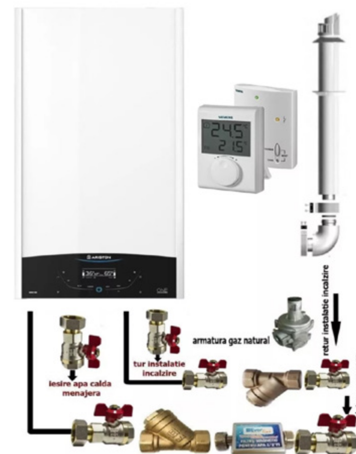
Fig.1 Centrala pe gaze și instalație de utilizarea gazelor naturale [1]
