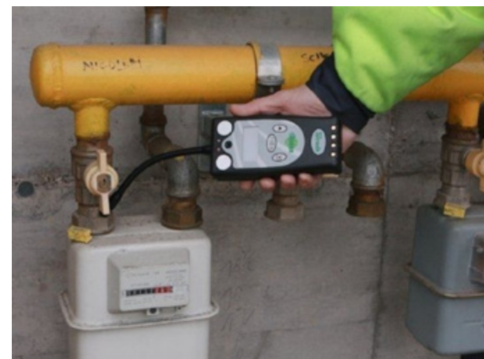
Fig.2 Verificarea contorului de gaze [2]
